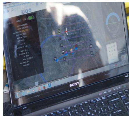
13-сурет. ҰҰА ұшып өту схемасы және оны самолет бортына (жадысына қондыру)
